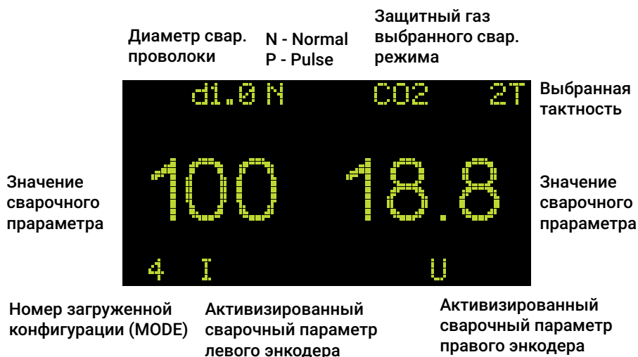
Рис. 10 — Главный экран панели управления
