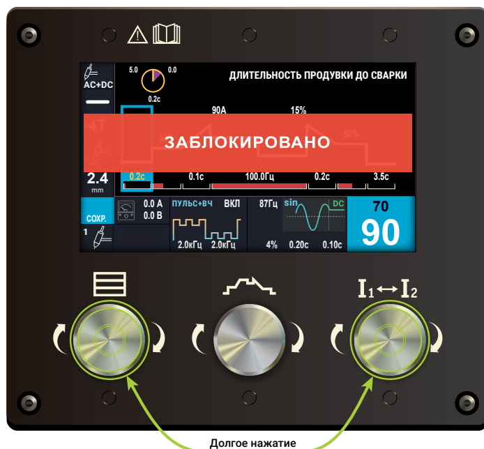
Рис. 13 – Принцип блокировки панели управления
