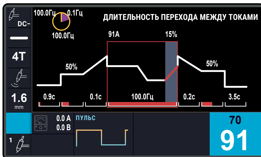
Рис. 24 – Изменение длительности перехода между токами при активированном параметре БАЛАНС
