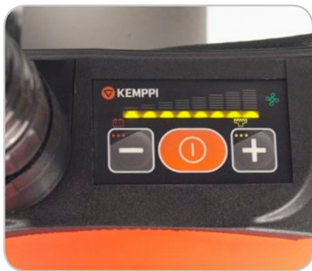
Блок фильтрации FreshAir Flow control автоматически регулирует скорость вращения двигателя вентилятора с учетом засорения фильтра и уровня заряда аккумулятора.
