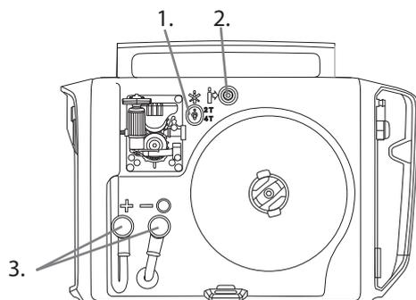
1. Переключатель режимов работы сварочной горелки.
