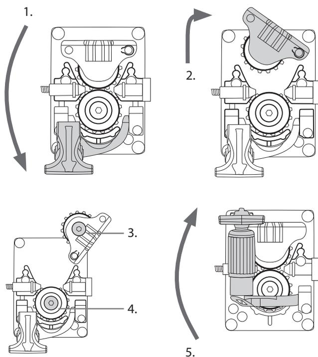
При использовании твердой порошковой проволоки для достижения лучшего захвата следует выбирать рифленый подающий ролик.
