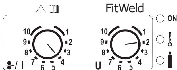
Установите значение скорости подачи сварочной проволоки при помощи регулятора (1). Максимальное значение составляет 18 метров в минуту.
