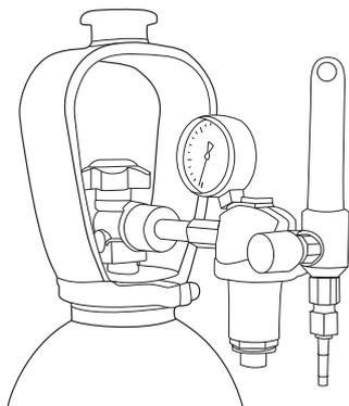
1. Подсоедините шланг защитного газа к регулирующему клапану газового баллона и затяните соединитель (соединитель не входит в комплект поставки).
