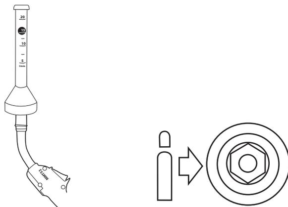
**ВНИМАНИЕ!** Скорость подачи защитного газа, установленная на регуляторе газового баллона, должна превышать скорость подачи, измеренную на сварочной горелке. Если эти значения одинаковы, на панели управления загорится индикатор подачи газа. При этом сварка невозможна.
