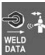
Тумблером WELD DATA на дисплее возвращаются те параметры скорости подачи, тока и напряжения, которые предыдущий раз применялись при окончании сварки. Значения отображаются во время нажатия тумблера и сохраняются в памяти до следующего нажатия кнопки горелки.
