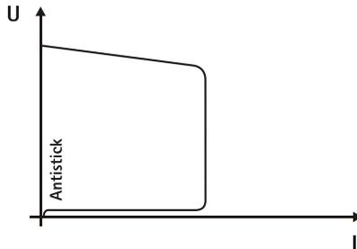
**Устройство Antistick предотвращает прокаливание электрода.**
