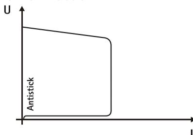
**Устройство Antistick предотвращает прокаливание электрода.**
